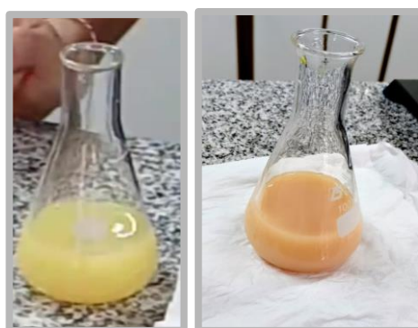
Figura 7. Cambio de color en la titulación argentométrica de cloruros (método de Mohr). Nota: Fotografías tomadas en el laboratorio de la Facultad de Ciencias Aplicadas a la Industria.
