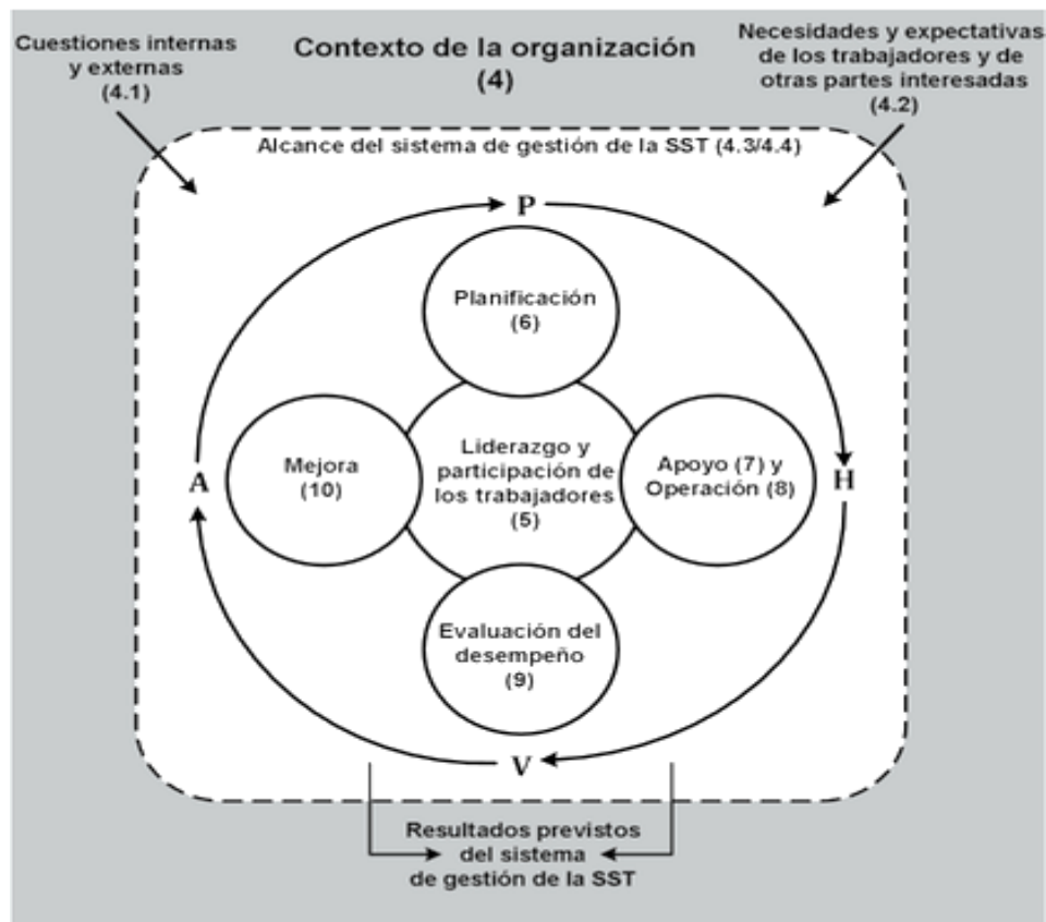
Figura 2 Relación entre el PHVA de la figura 1 y el marco de referencia de la Norma ISO 45001
